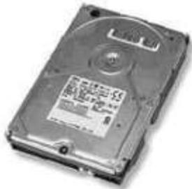
**Hard disk o Disco fisso:** è un disco interno all'unità centrale e non estraibile (da ciò il nome). E' la memoria di massa più veloce e può contenere grandi quantità di dati; quelli attualmente in commercio hanno una capacità che va da 4,3 a 34 GigaByte (cioè 4,3 - 34 miliardi di caratteri).
